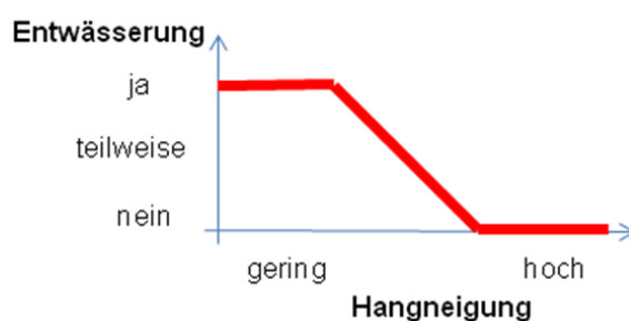
Abb. 1: Prinzip der konventionellen und der Fuzzylogik am Beispiel der Einflussgröße Hangneigung.
