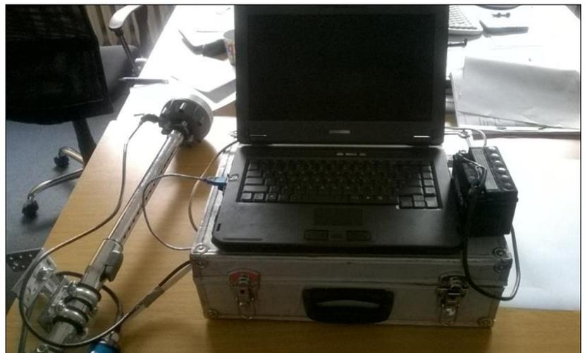
Abbildung 2: Zweifrequenz-Echolot mit der Auswerteeinheit (Laptop), Stromversorgung und DGPS-Empfänger mit RTK (EGNOS) SmartV1
