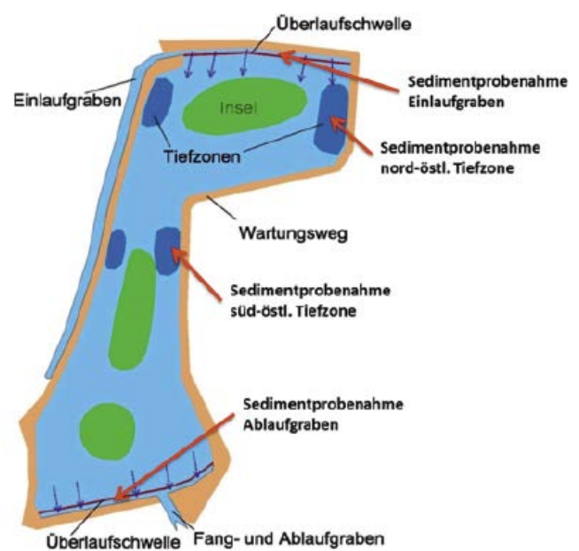
Abb. 2: Schema der funktionalen Gestaltung des Feuchtgebietes mit eingetragenen Sediment-Probestellen, geändert nach [7]
