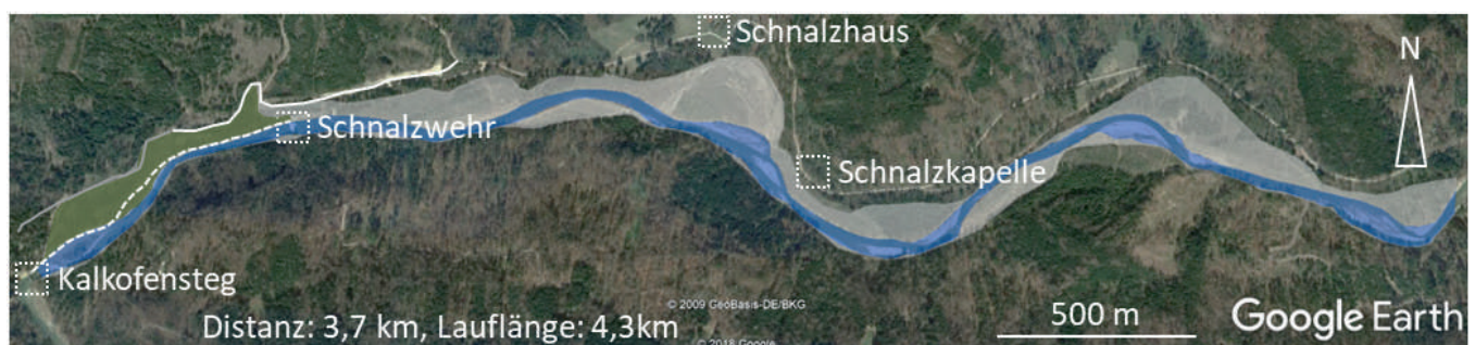
Abb. 3: Potentieller Entwicklungsraum der Ammer (weiße Fläche) im Vergleich zum aktuellen Verlauf (blaue Fläche); der grüne Bereich zeigt die momentan abgetrennte Aue, gestrichelt in weiß der bisherige Dammverlauf, durchgezogen der neue Damm, in grau der neu anzulegende Wanderweg; eigene Grafik auf Luftbild von Google Earth. (© 2009 Geo Basis DE/BKG)
